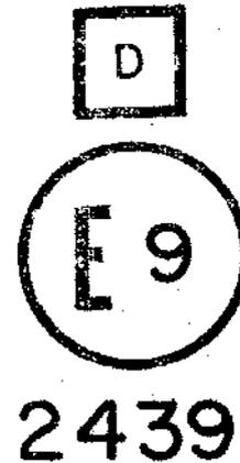
El cinturón que lleva la anterior marca de homologación es un cinturón diagonal («D») homologado en España (E9) con el número 2439, desprovisto de dispositivo de absorción de energía.
