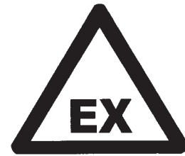
Zona con riesgos de atmósferas explosivas
