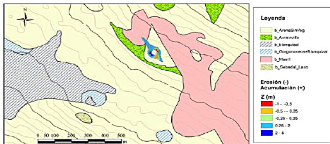
Figura 8. Zona afectada por la erosión/sedimentaria debido a la instalación de la estructura GBF y cartografía bionómica del entorno cercano. Fuente: IHCantabria, 2016
