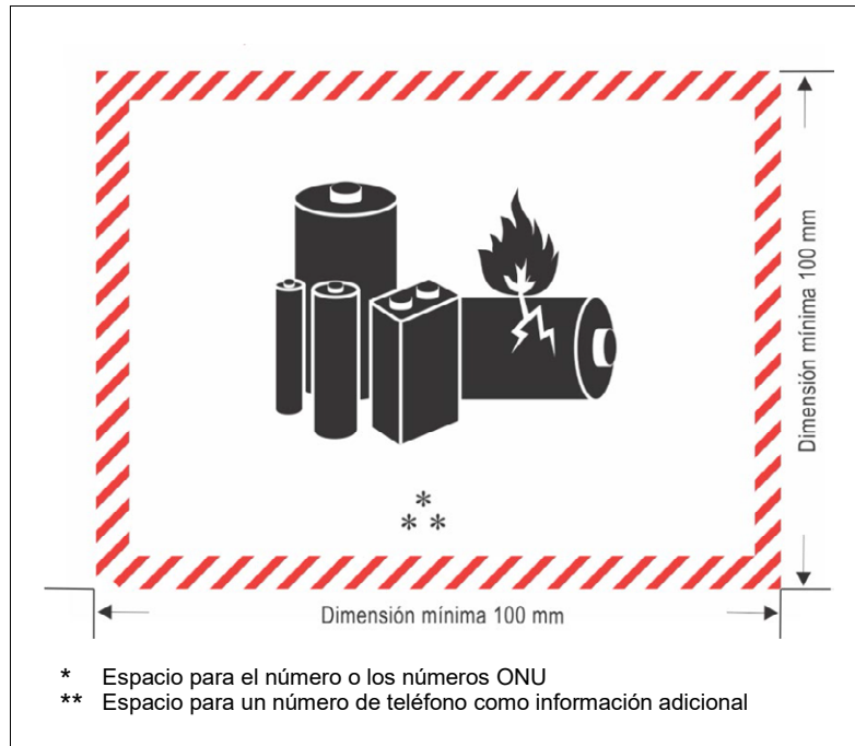
Figura 5-3. Marca de baterías de litio
