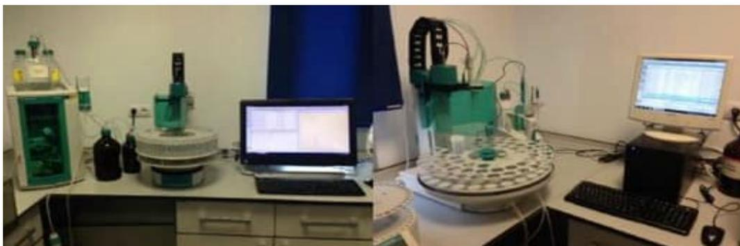
Figura 5: Cromatógrafo para el análisis de aniones (izquierda) y para la determinación de la alcalinidad total (derecha) en el laboratorio del CEHIUMA
