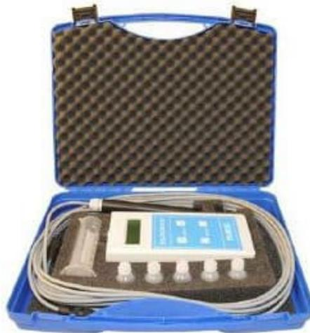
Figura 2: Aforador químico Modelo Salino MADD (MADD Technologies)
