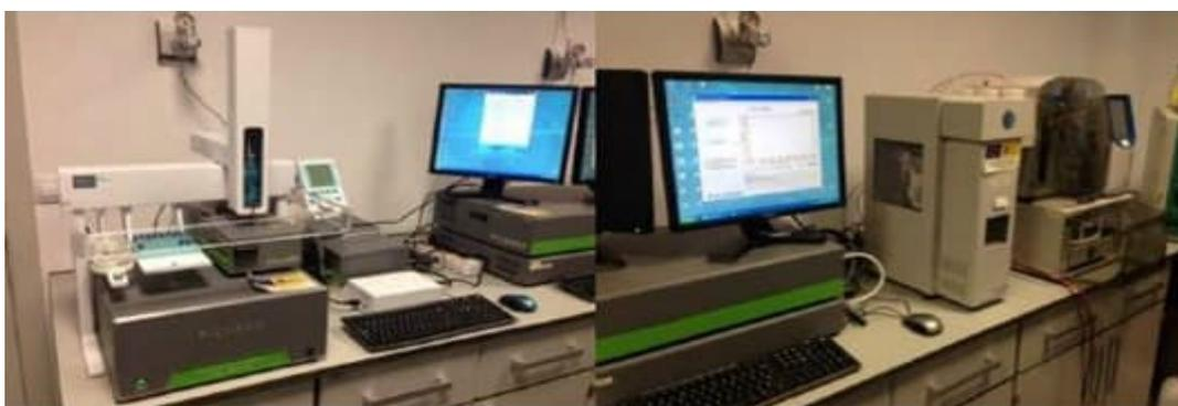
Figura 7: Equipo PICARRO L2120i- CRS para el análisis de los isótopos de la molécula de agua (izquierda) y equipo PICARRO G1111i- CRDS para el análisis de  $^{13}\text{C}$  (derecha) en el laboratorio del CEHIUMA
