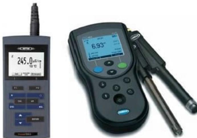
Figura 4: Equipos para la medida in situ de la conductividad eléctrica y temperatura del agua (WTW, modelo 3310 –derecha–) y del Ph y oxígeno disuelto (Hach- Lange, modelo HQ40d –izquierda–)
