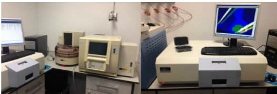
Figura 6: Equipo Shimadzu TOC-V CSN para los análisis de COT y NT (izquierda) y espectrofluorímetro PERKIN ELMER LS-55 (derecha) en el laboratorio del CEHIUMA
