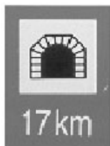
Sinal E11A do Convenio de Viena correspondente a os túneles de estrada
