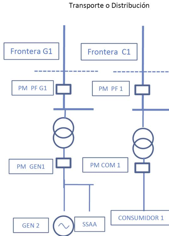
AUTOCONSUMO COLECTIVO A TRAVÉS DE RED, CON INSTALACIÓN EN RED INTERIOR (Típico 14).
