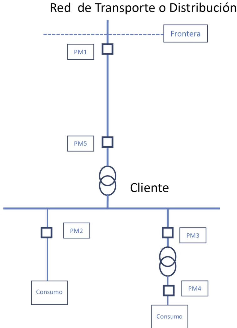
FRONTERAS DE DISTRIBUCIÓN CON TRANSPORTE (Esquema típico 6).
