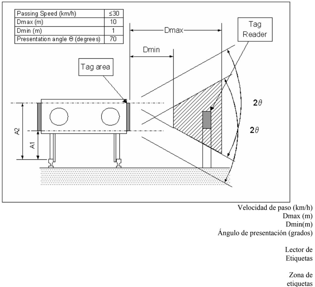
Fig. 3 Limitaciones de instalación del lector de etiquetas
