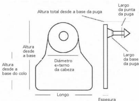
Ilustración -2 Detalle de brinco tipo bandeira - peza macho
