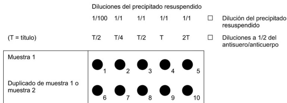
Figura 1. Preparación del portaobjetos de acuerdo con el punto 4.1, inciso i), y el punto 4.3, inciso i)
