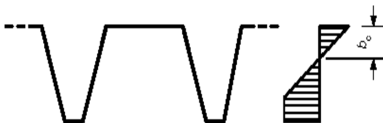
Figura 73.11.1. Distribución plástica de tensións na parte traccionada
