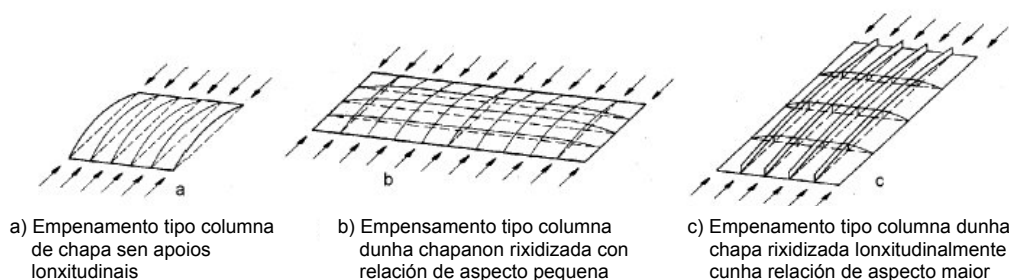
Figura A6.3. Empenamento tipo columna
