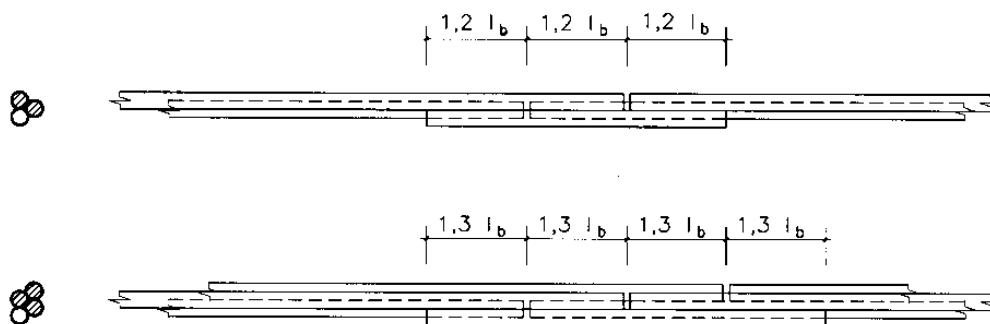
Figura 49.5.2.3 Empalmes por solapo de grupos de barras
