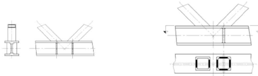
Figura A26.7.7 Rigidizadores para cordones con perfiles en I
